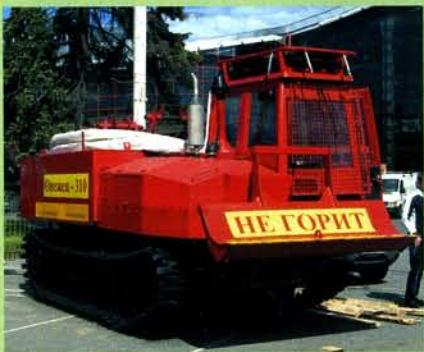
идет на замену трактора ЛХТ-100А-12, от которого выгодно отличается увеличенной площадью опорной поверхности. Новая вибро- и шумоизолированная кабина снабжена каркасом безопасности, отвечающим требованиям стандартов FOPS, ROPS и OPS.
